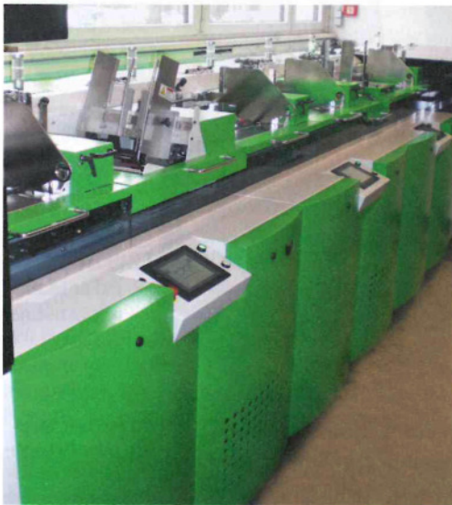
Das Kuvertiersystem verfügt über sechs Beilagenstationen mit unterschiedlichen Beilagenanlegern zur Verarbeitung eines breiten Materialspektrums.
